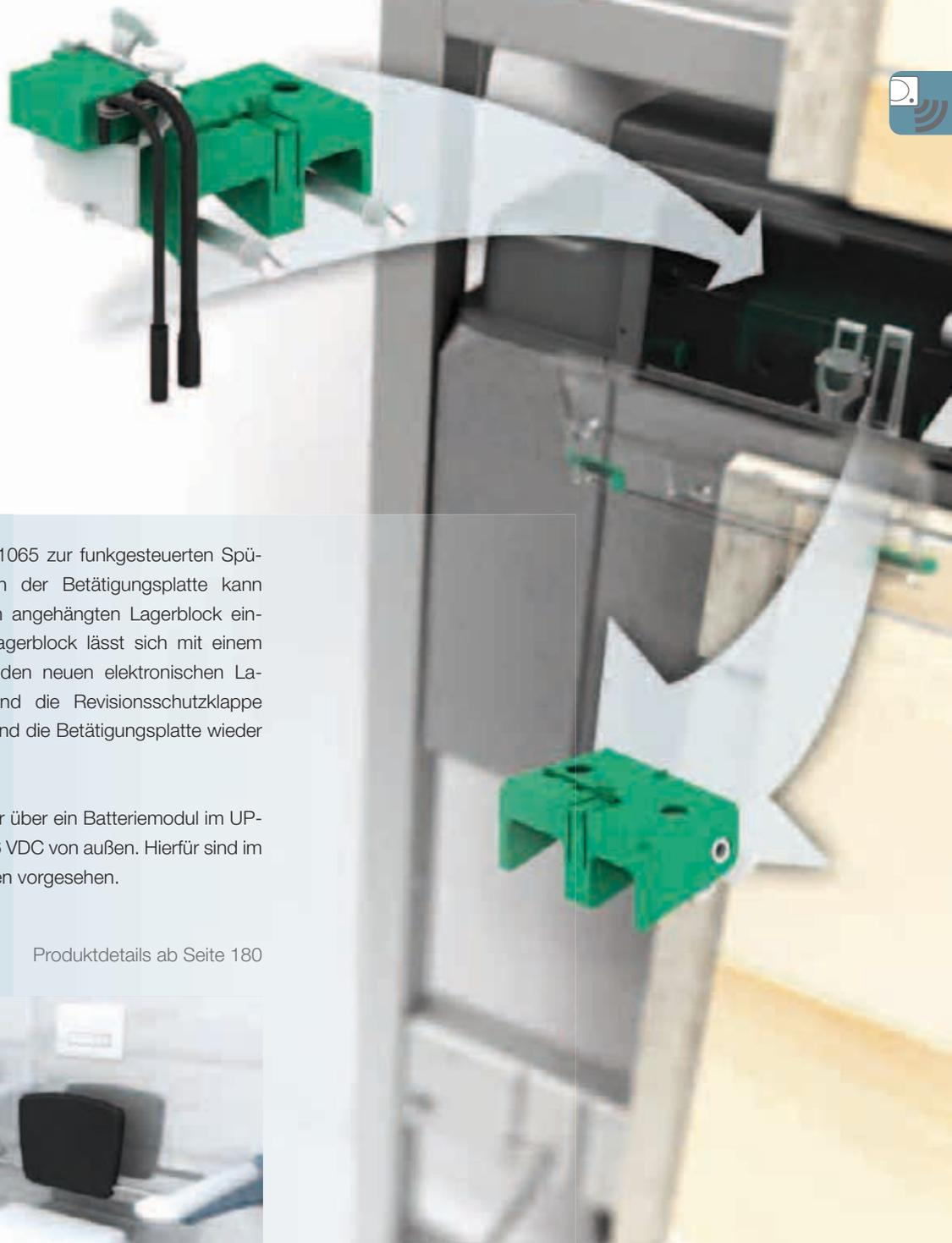
Beispielsweise mit der Sanicontrol 1065 zur funkgesteuerten Spülauslösung. Nach dem Abnehmen der Betätigungsplatte kann die Revisionsschutzklappe mit dem angehängten Lagerblock einfach abgenommen werden. Der Lagerblock lässt sich mit einem einfachen Klick-Mechanismus durch den neuen elektronischen Lagerblock austauschen. Anschließend die Revisionsschutzklappe einsetzen, hörbar einrasten lassen und die Betätigungsplatte wieder aufsetzen. Fertig im Handumdrehen.
